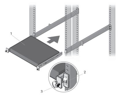
FIGURE 5-6. FRONT RACK INSTALLATION
