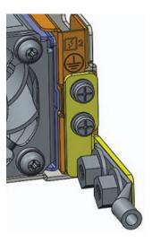
FIGURE 4-2. ATTACH THE GND LUG ASSEMBLY
