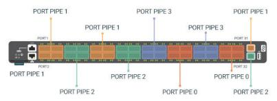
FIGURE 5-7. PORT PIPES
