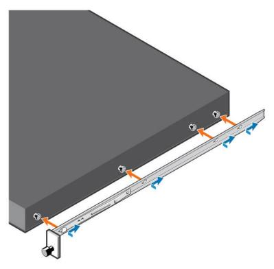
FIGURE 4-6. SWITCH RAILS ATTACHMENT
