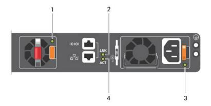
FIGURE 2-4. PSU SIDE LEDS ON THE SWITCH
