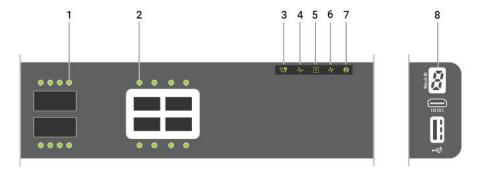
FIGURE 2-3. LEDS ON THE I/O SIDE OF THE SWITCH
