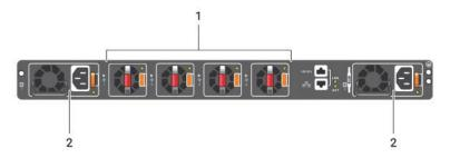
FIGURE 2-2. BACK PANEL OF THE SWITCH
